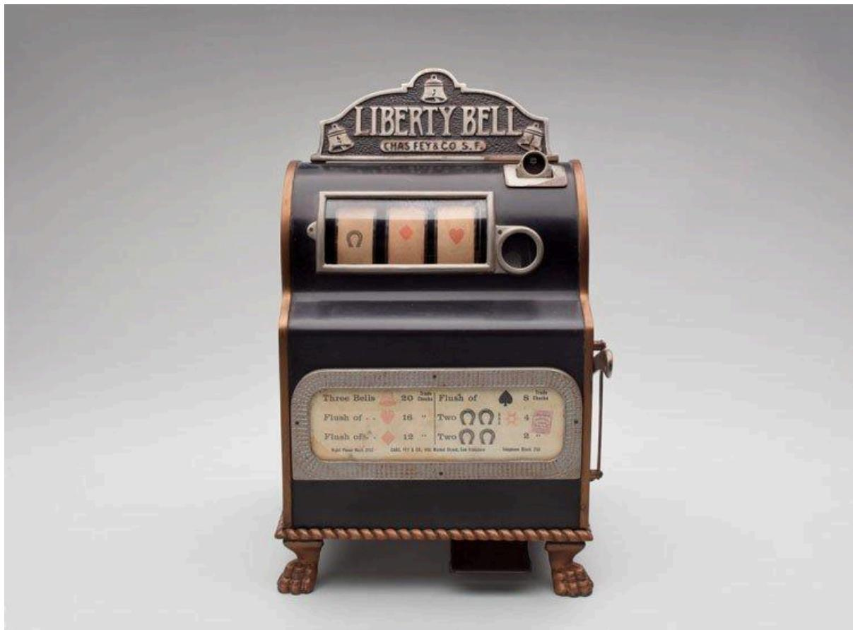
Принцип действия механических, а впоследствии и электро-механических аппаратов основан на независимом вращении трех барабанов на одной оси и поочередной остановке катушек. В случае, если на видимой части барабанов оказывались одинаковые знаки, гемблеру выдавался выигрыш.
